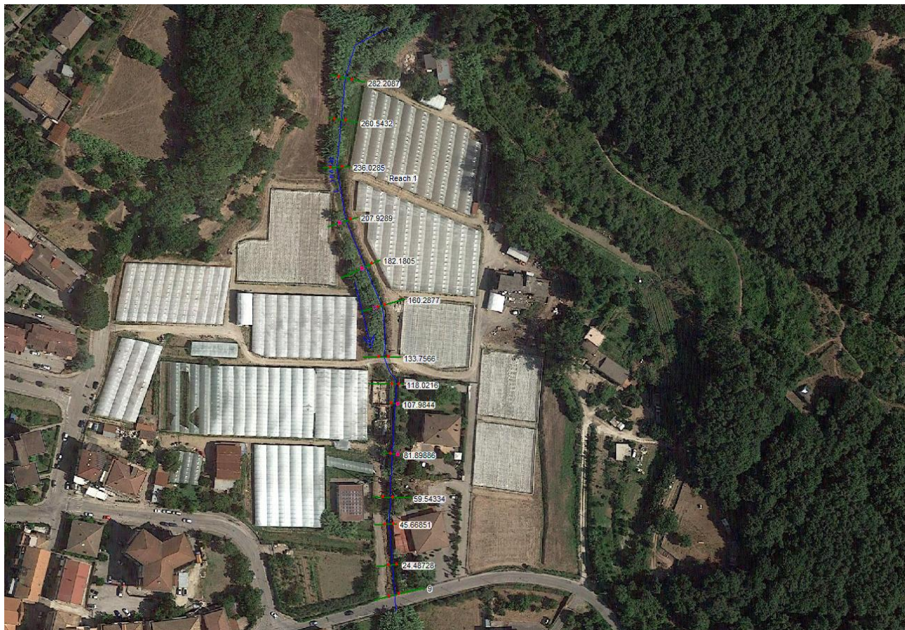
Figura 5 –Inserimento delle sezioni rilevate nel software Hec-Ras.
